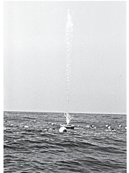
Глубинный насос использует только энергию волн.
