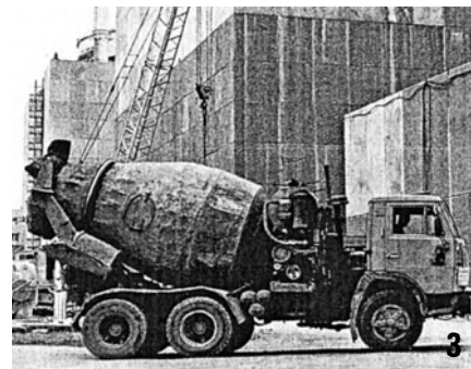
Смеситель с приводом от ДВС на базе грузовика КамАЗ.
