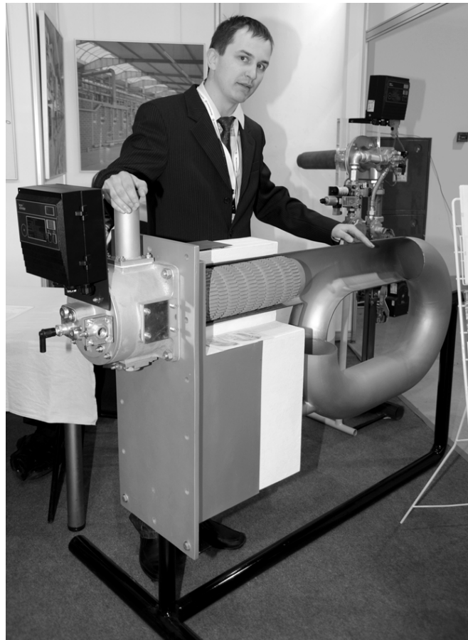
Горелка с рекуператором тепла экономит топливо и металл.
