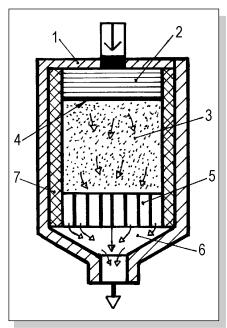
поры заряда 3. При этом вследствие дросселирования он интенсивно охлаждается и теряет взвешенные в нем твердые частицы (грубая очистка). Тонкую очистку кислород проходит в фильтрах 5, из которых через фильеру 6 поступает к потребителю. Теплозащита 7 предохраняет пользователя от ожогов.
