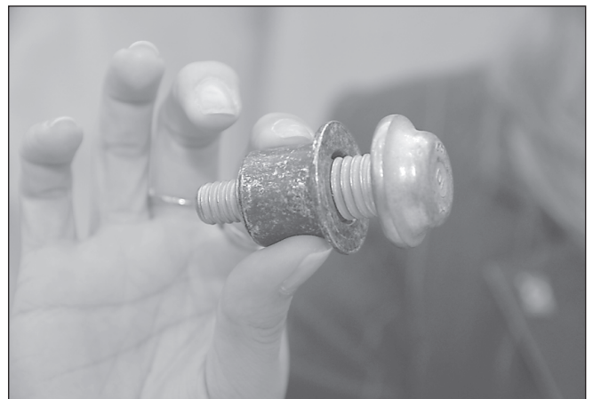
Фото 2. Новые обжимные болты с гайками без резьбы.
