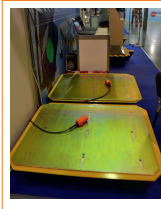
Детектор для диагностики ходовой части и рулевого управления транспортным средством
