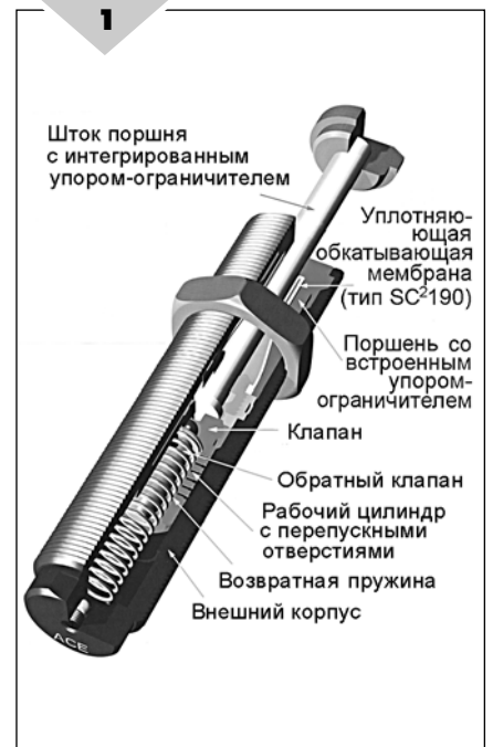
Так устроен один из демпферов.
