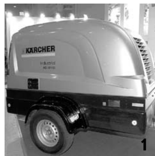
Компактная установка для очистки ледяной дробью.
