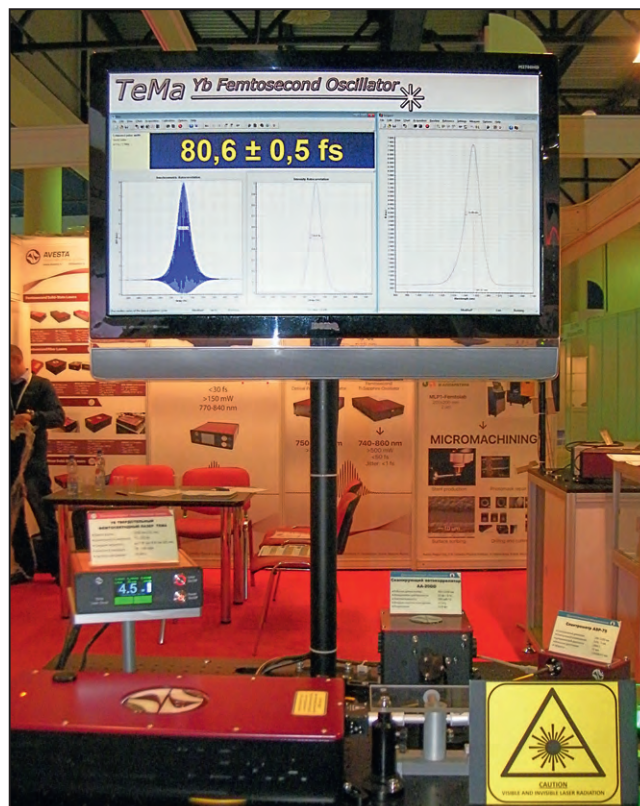
Фото 4. Фемтосекундная техника московской компании «Авеста-Проект» — лазер на хром-форстерите, регенеративный усилитель «ТЕТА»
