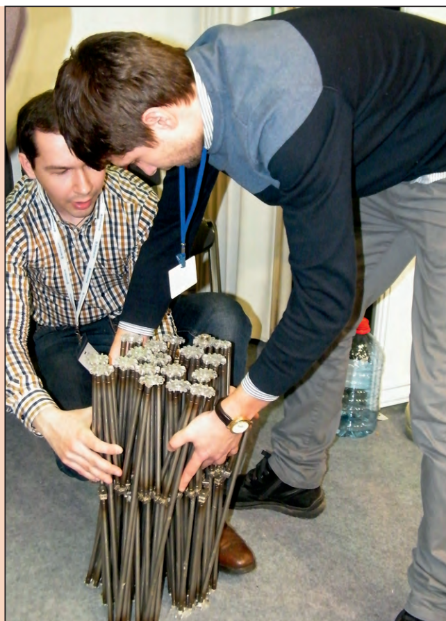
Фото 1, 2. Трансформируемая ферменная конструкция, в собранном виде легко уместяющаяся в обычной дорожной сумке
